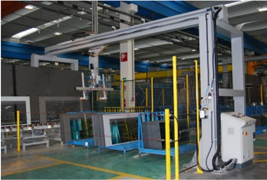
Chargeuse à Axes Cartésiens
